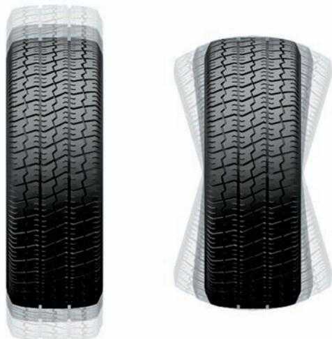
**Дисбаланс колеса — результат воздействия статических и парных сил. Статические силы приводят к «подпрыгиванию» колеса, парные вызывают боковые колебания.**
