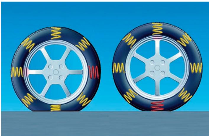
В борьбе с нарушением плавности хода автомобиля, вызванным силовой неоднородностью колеса, традиционная технология балансировки бессильна.
