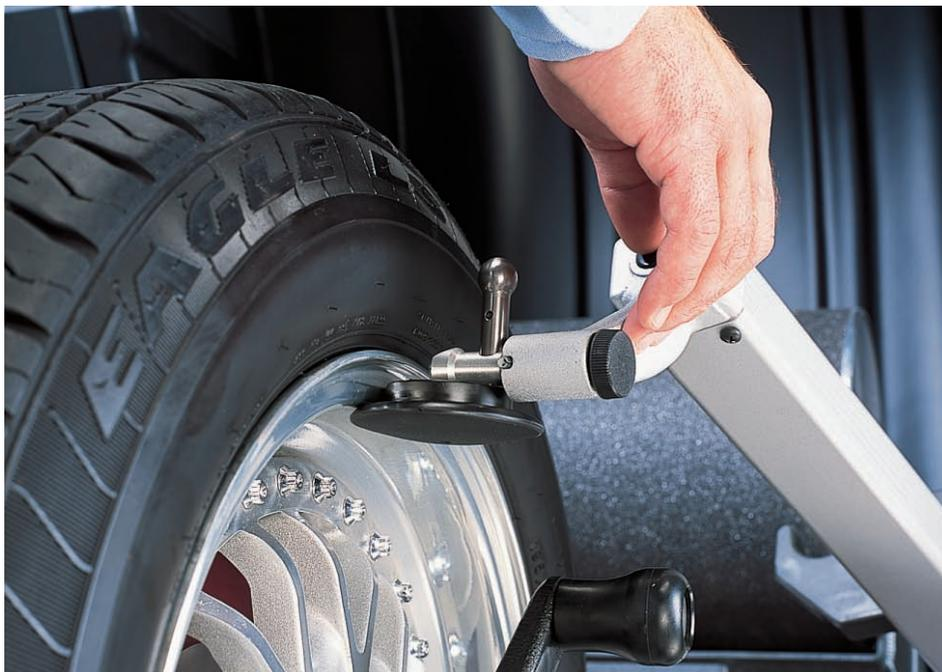
Радиальные и боковые биения диска определяются с помощью измерительного приспособления.
