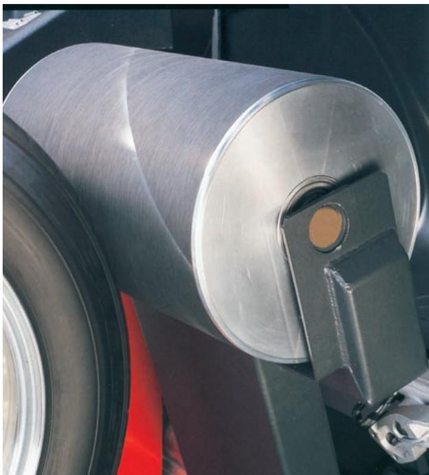
Прижимной ролик системы Road Force Measurement нагружает вращающееся колесо усилием более 600 кг.
