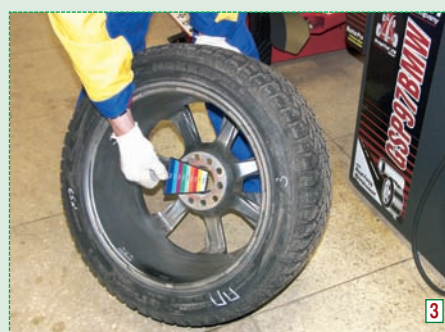
Для быстрого выбора нужного центрирующего приспособления используем шаблон.
