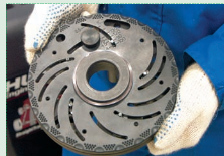
В универсальный фланцевый адаптер установлены пять пальцев. Регулируем их расположение так, чтобы они совпали с отверстиями в диске, и стопорим винтом.
