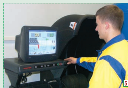
Проведя измерительный цикл, обрабатываем результаты по традиционной технологии. Дисбаланс устраняется установкой двух грузов 30 и 10 г на внутренней и внешней плоскостях колеса соответственно.
