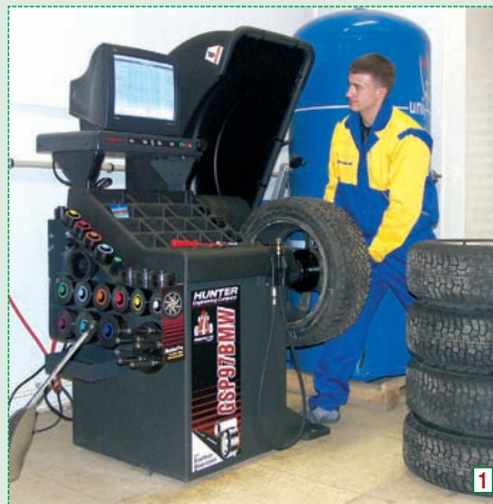
В эксперименте принимают участие: станок Hunter GSP97BMW (версия для дилеров концерна BMW), комплект колес, состоящих из 15-дюймовых дисков, «обутых» в шипованную резину 205/65 R15 и... мастер Данила.
