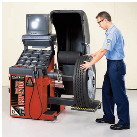
Пневмолифт не только экономит силы шиномонтажника, но и помогает аккуратно и точно закрепить колесо.
