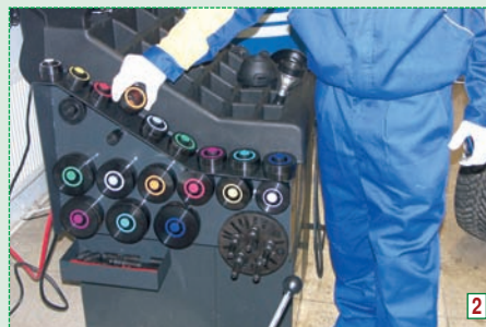
Это самый полный комплект «колет точной посадки». Центрирующие конусы имеют цветовую маркировку.
